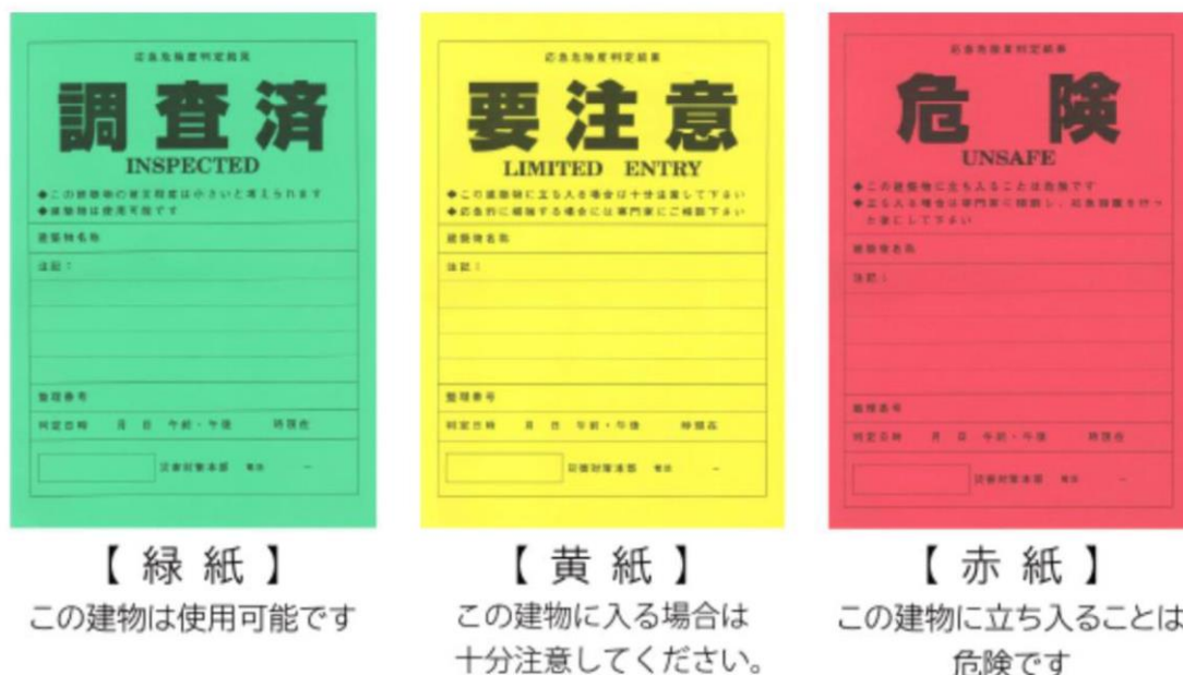
図 3.4 応急危険度判定で「調査済」、「要注意」、「危険」を表示するステッカーの例
