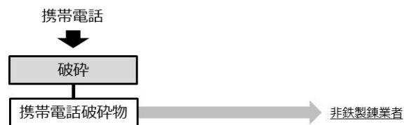
図 『携帯電話』の処理フロー
