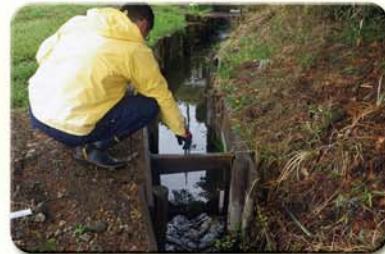
写真2 流速、水深を計測し流量を算出
