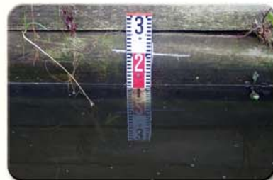
写真1 水路に設置した水位標
