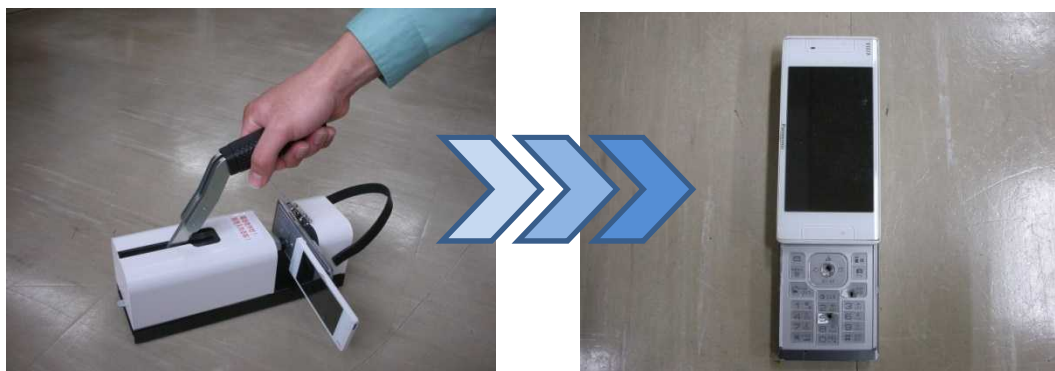
写真 2-6 携帯電話穿孔機と穴あけの状況
