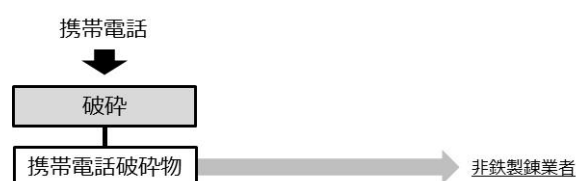
図 『携帯電話』の処理フロー
