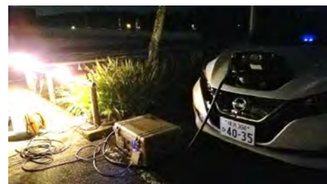
令和元年房総半島台風による千葉県の停電地域への支援の例（横浜市資料より 88 ） （写真提供 日産自動車株式会社）
