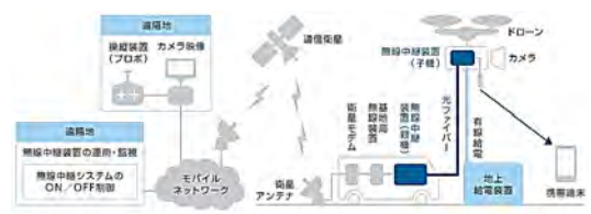
有線給電ドローン無線中継システム （図の提供 ソフトバンク株式会社）
