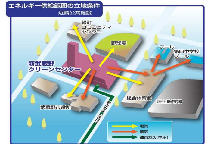
公共施設のエネルギー供給拠点
