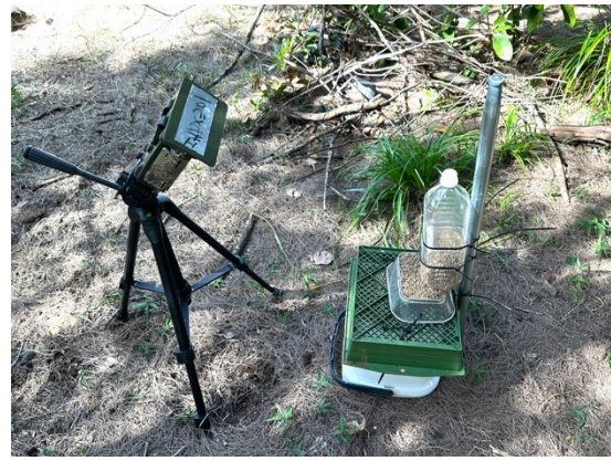
写真2 自動給餌器の設置状況
