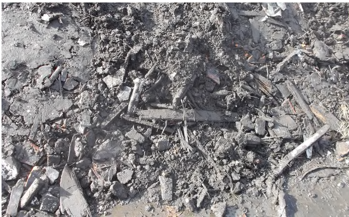
写真 4-1-(6)-1 埋立処分した炭状の木くず（土砂と混合状態）
