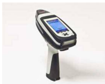
出典：石綿飛散漏洩防止対策徹底マニュアル〔2.10版〕平成29年3月 厚生労働省 写真 携帯型アスベストアナライザー（マイクロフェーザー）
