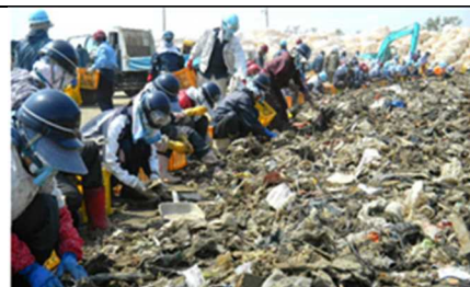
手選別（宮城県東松島市） 出典：東日本大震災により発生した被災3県における災害廃棄物等の処理の記録
