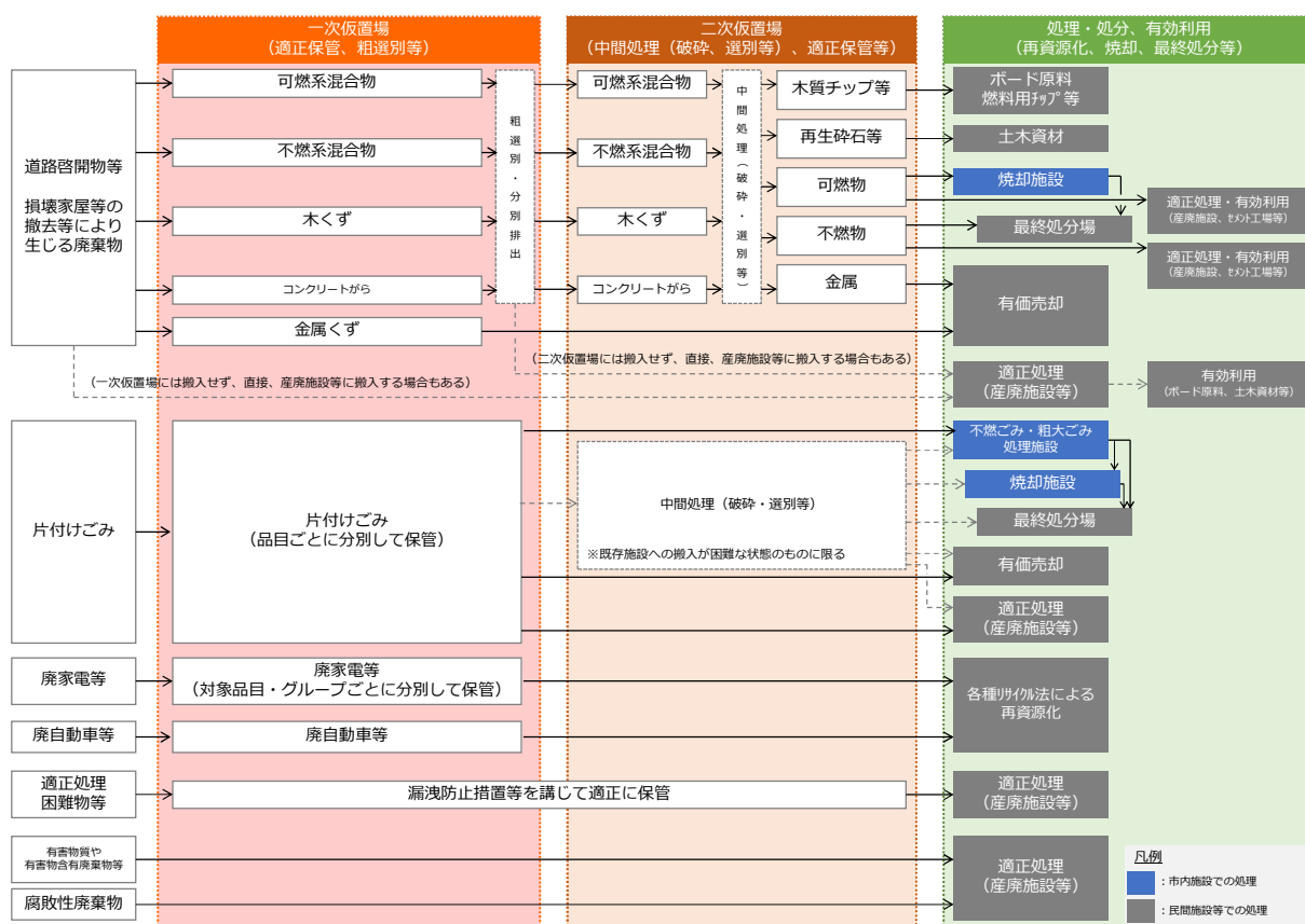
図 5-8 災害廃棄物の概略処理フロー
