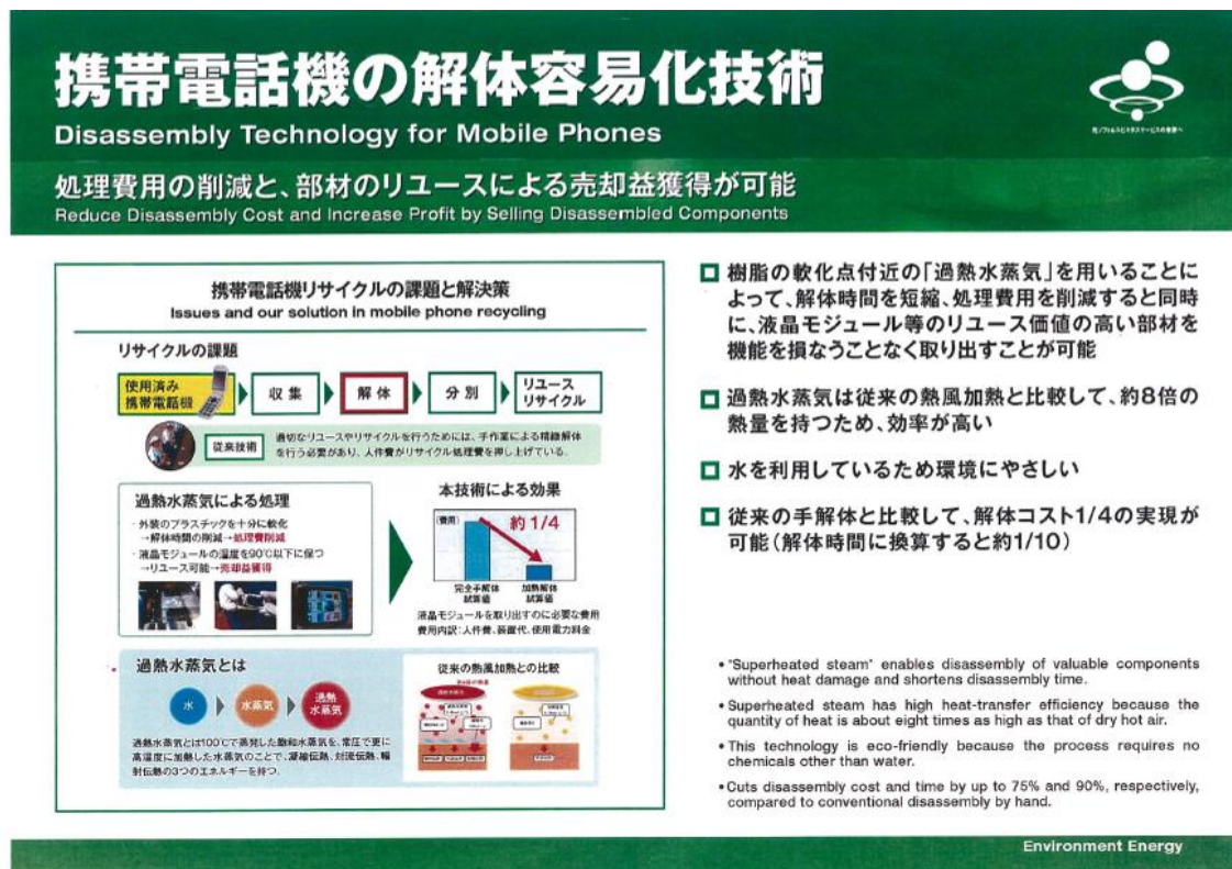
図 4-7 過熱水蒸気を用いた携帯電話の解体容易化技術
