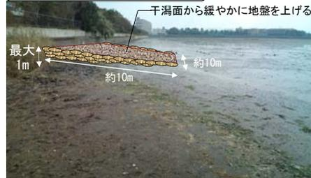
嵩上げ試験の施工断面
